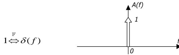
Fig. 2.38 Module de la transformée de Fourier d'une constante
